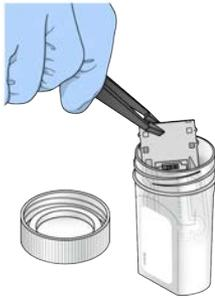
3. Spülen Sie die Fließzelle leicht mit Wasser in Laborqualität und stellen Sie sicher, dass sowohl das Glas als auch die Kunststoffkartusche gründlich von Salzablagerungen befreit werden. Salzablagerungen beeinträchtigen den Sitz der Fließzelle im Gerät. Wenn Salzablagerungen im Bildgebungsbereich antrocknen, kann die Bildgebung ebenfalls beeinträchtigt werden.
