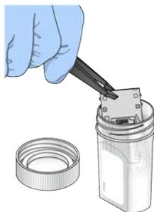
3. Слегка промойте проточную ячейку ультрачистой водой, убедившись, что пластиковый и стеклянный картриджи тщательно промыты от избытка солей. Избыток солей может стать препятствием для надлежащей установки проточной ячейки в прибор. Скопление высохших солей в визуализируемой области может негативно повлиять на качество визуализации.
