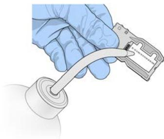
4. Уделяя особое внимание поверхности вокруг черной прокладки порта проточной ячейки (указано на рисунке ниже), тщательно высушите проточную ячейку и картридж с помощью безворсовой салфетки для очищения линз. Промакивающими движениями аккуратно высушите область прокладки и прилегающего стекла.
