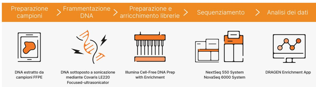
Figura 1: flusso di lavoro dell'Illumina Cell-Free DNA Prep with Enrichment per l'elaborazione di campioni FFPE.
