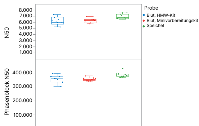
Abbildung 10: Hochwertige Leistung bei verschiedenen Probentypen: Bibliotheken von Illumina Complete Long Read Prep, Human, die aus Blut (HMW, mini) und Speichel generiert wurden, liefern hochwertige Daten, gemessen anhand von N50 und Phasenblock N50.
