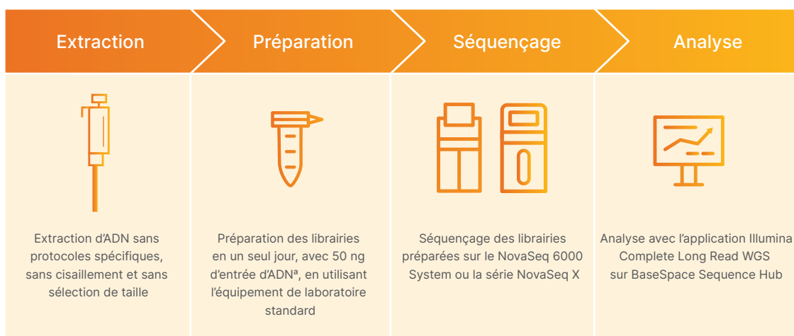
Figure 1 : Flux de travail d'Illumina Complete Long Read Prep, Human – Illumina Complete Long Read Prep, Human offre un flux de travail rationalisé composé de quatre étapes : extraction d'ADN, préparation des librairies, séquençage et analyse des données.
